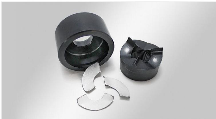
Les ensembles poinçons matrices ronds peuvent perforer des tôles d'acier inoxydable (versions V2A), d'acier ou d'aluminium et plastique jusqu'à 3mm (V2A: max. 2 mm) d'épaisseur. Ces poinçons sont destinés à faire des ouvertures dans les tailles PG 16, M16, M20, M25, M32, M40, M50, M63, M75, M80 et M85 qui correspondent à les [presse-étoupes](#) et [systèmes passe-câbles](#) d'icotek.
